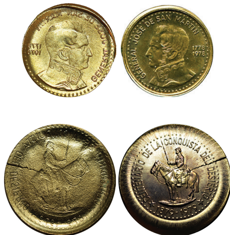
Esta pieza presenta además del diseño incuso, una notable expansión producto de la ausencia de collar y probablemente de varios golpes consecutivos. Es posible que en el cuño opuesto se haya formado una tapa de cuño
