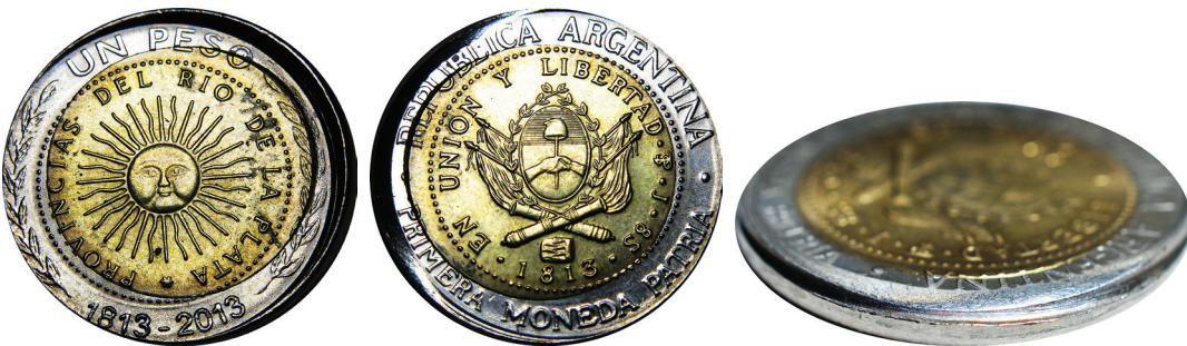
El collar inclinado en monedas bimetálicas produce efectos en en núcleo
