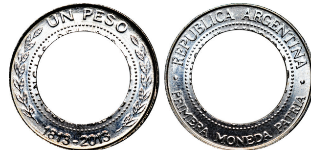
Anillo acuñado sin núcleo. El desplazamiento del metal es hacia adentro ya que hacia afuera esta contenido por el collar
