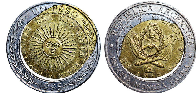
Inserción descentrada del núcleo. La "ventana" es característica de este error
