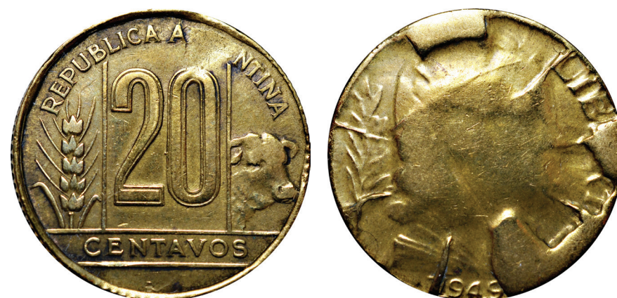
Rotura masiva de cuño martillo. Probablemente esta sea la última pieza obtenida de dicho troquel
