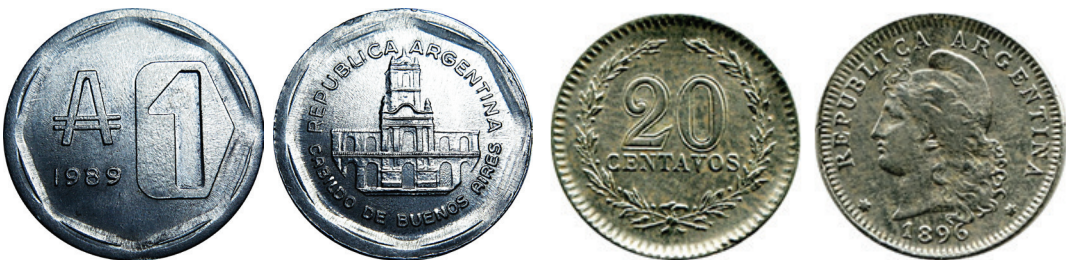
Izq: Acuñaación con y sin collar Der: Sin collar. Canto liso y modulo expandido
