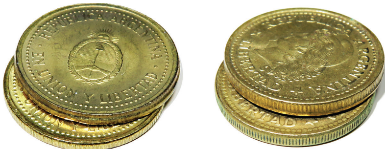
Cantos coronados por collar con altura incorrecta
