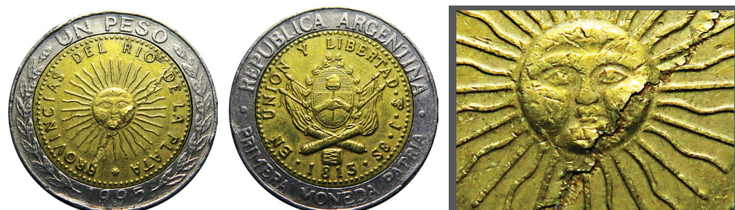
Laminación de núcleo en moneda bimetalica
