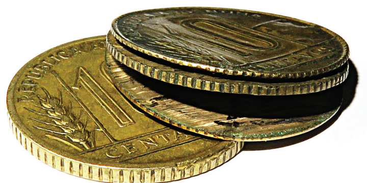
Cospel de 10 centavos de 1947 deslaminado en 3 partes
