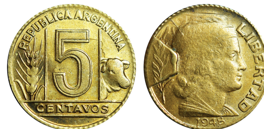
Quebradura de cuño sin desplazamiento. El mismo tipo de rotura que produce un descantillado pero el fragmento queda en su posición. Signos de fuerte choque de cuños en ambas caras, probable causa del daño
