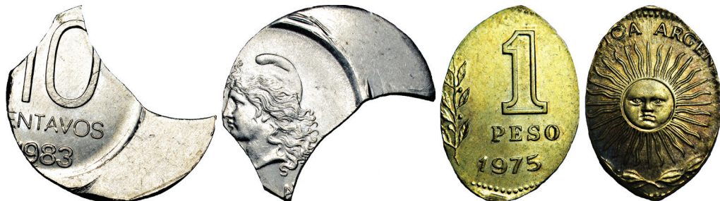
Izq: Doble casi creciente y acuñación descentrada Der: Capado elíptico
