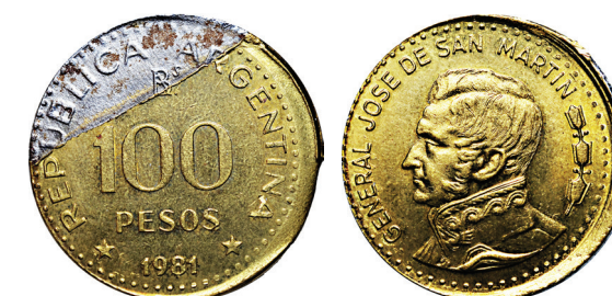
Falla de enchapado y descentrado
