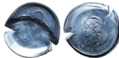
El aluminio tiende a quebrarse cuando es estirado en exceso
