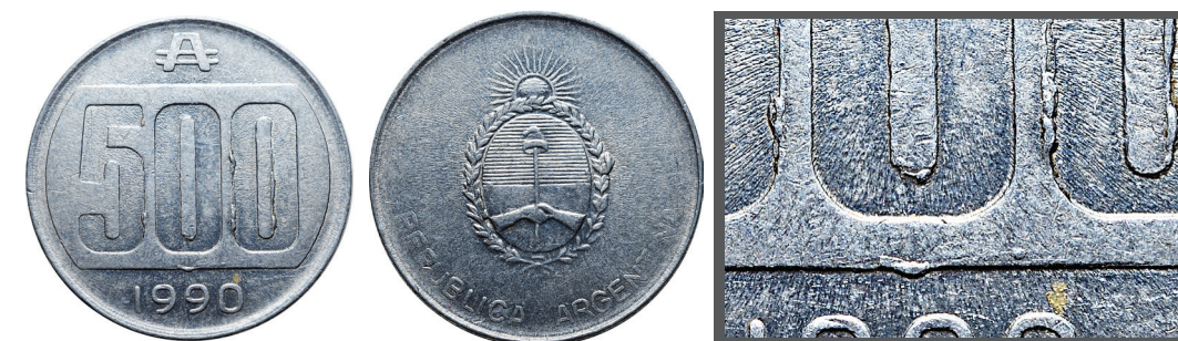
Daños del cuño por desgaste al interior de los números de la denominación
