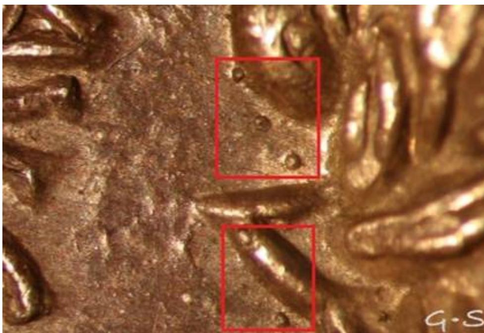
*Imagen 14.20. "Burbujas" en positivo en un denario falso acuñado de Augusto. Colección Mapila.*
