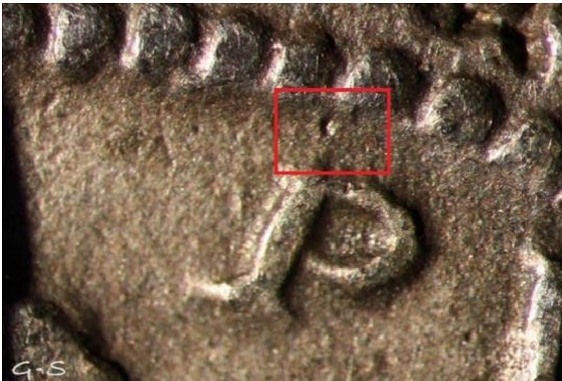
*Imagen 14.6. Burbuja de fundición sobre un denario falso de Geta. Colección GS.*
