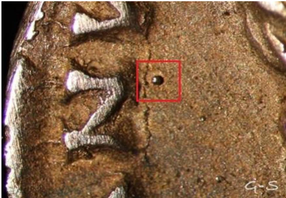
Imagen 14.13. Burbujas o depósitos de plata en una moneda fundida de Nerva. Colección GS.
