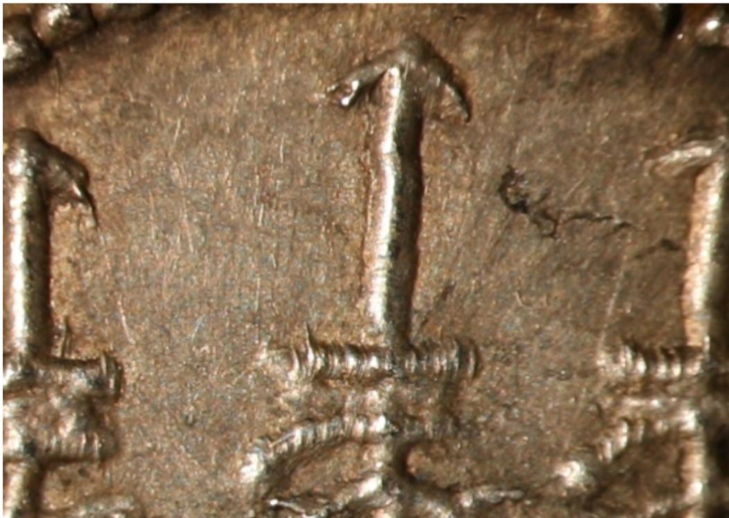
*Imagen 10.14. Líneas de flujo típicas de un denario falso por acuñación. Colección GS.*
