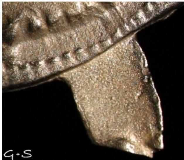
*Imagen 3.6. Bebedero parcialmente amputado en una de las copias obtenidas por micro-fusión. Más tarde, ese resto deberá ser debidamente cortado y pulido hasta borrar cualquier rastro de su existencia.*
