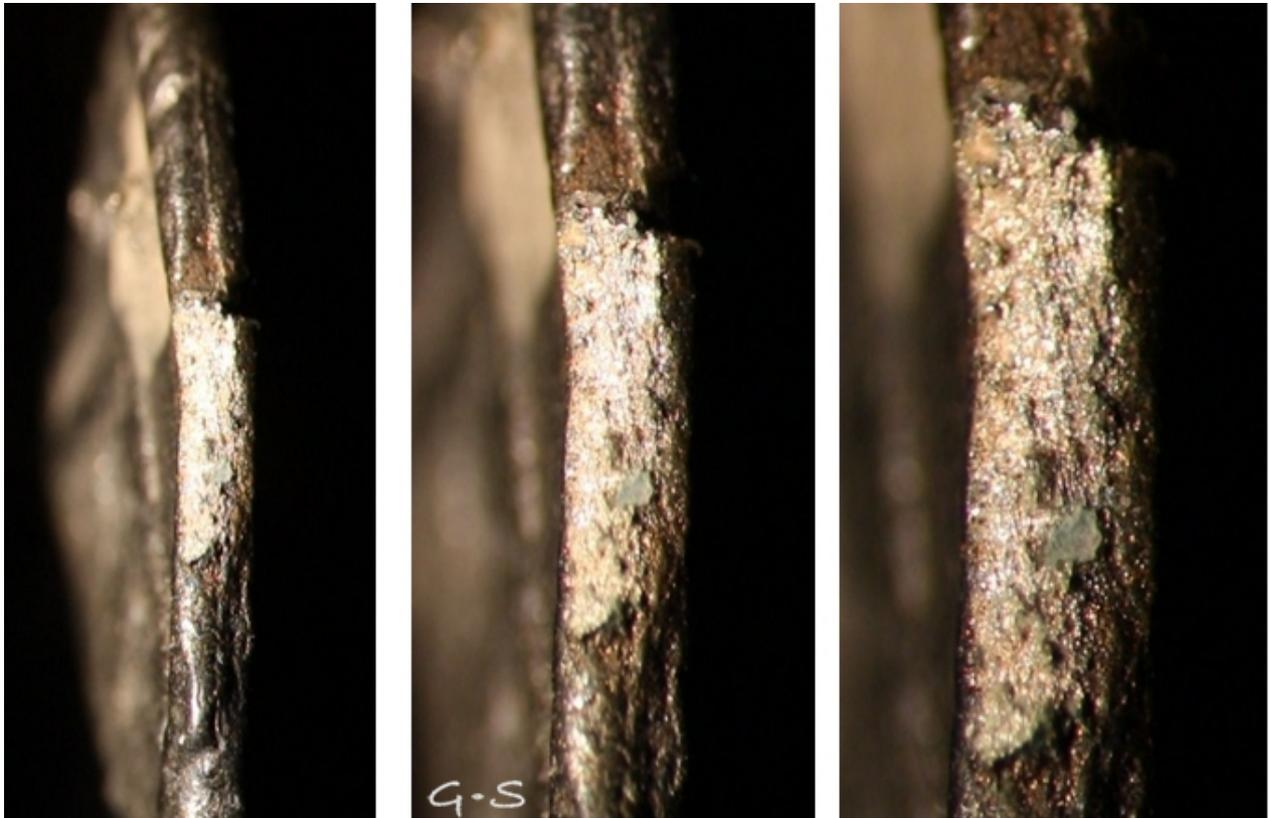
*Imagen 15.3. Secuencia fotográfica a 16, 25 y 40 aumentos respectivamente, mostrando el aspecto de un bebedero recién arrancado del canto de un denario clonado. Colección GS.*
