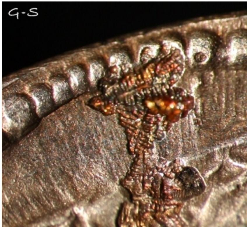
*Imagen 12.6. Corrosión provocada en un denario falso fundido de Adriano. Colección GS.*
