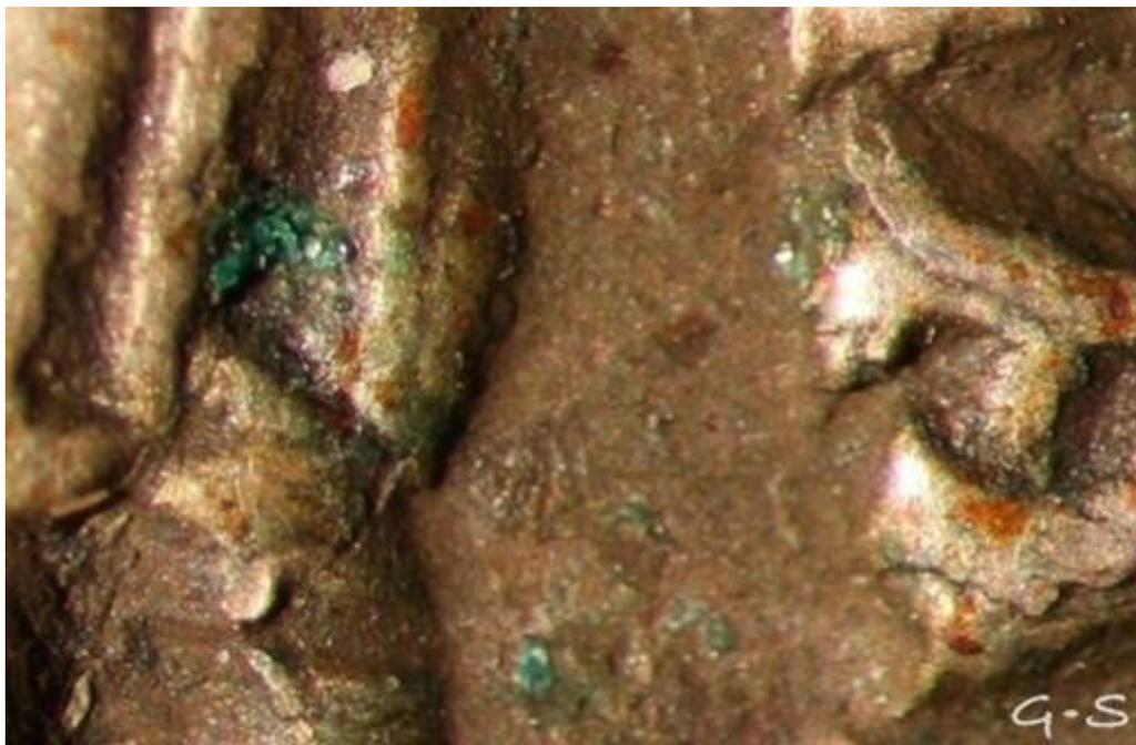
*Imagen 11.27. Concreciones sobre un denario falso de Cómodo con muchos años de antigüedad en diversas colecciones. Colección GS.*
