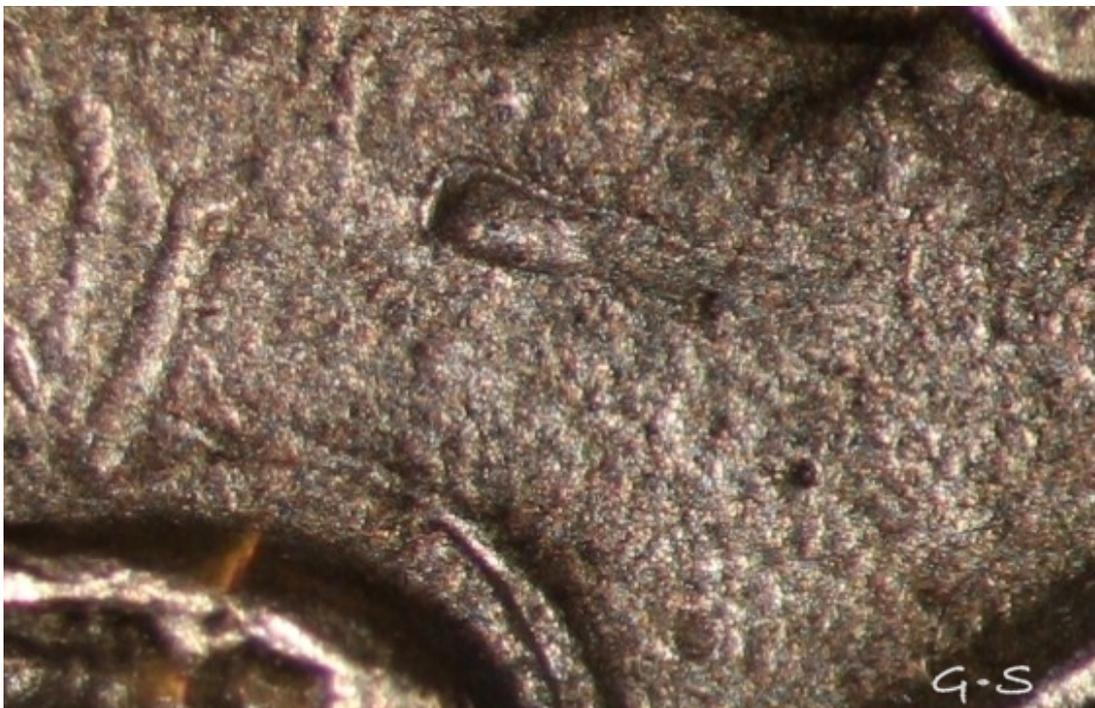
*Imagen 18.4. "Dedo en la mantequilla" sobre un denario falso fundido de Caracalla. Colección GS.*
