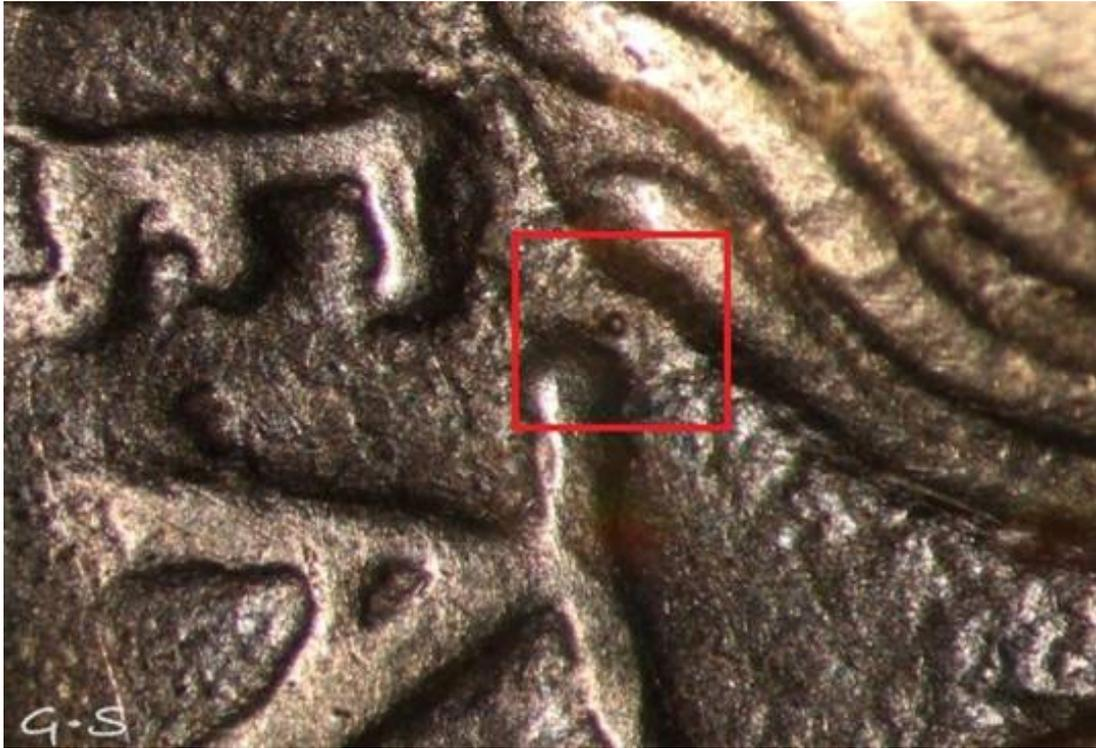
*Imagen 14.3. Burbuja de fundición sobre un denario falso de Gens Herennia. Colección Máximus*
