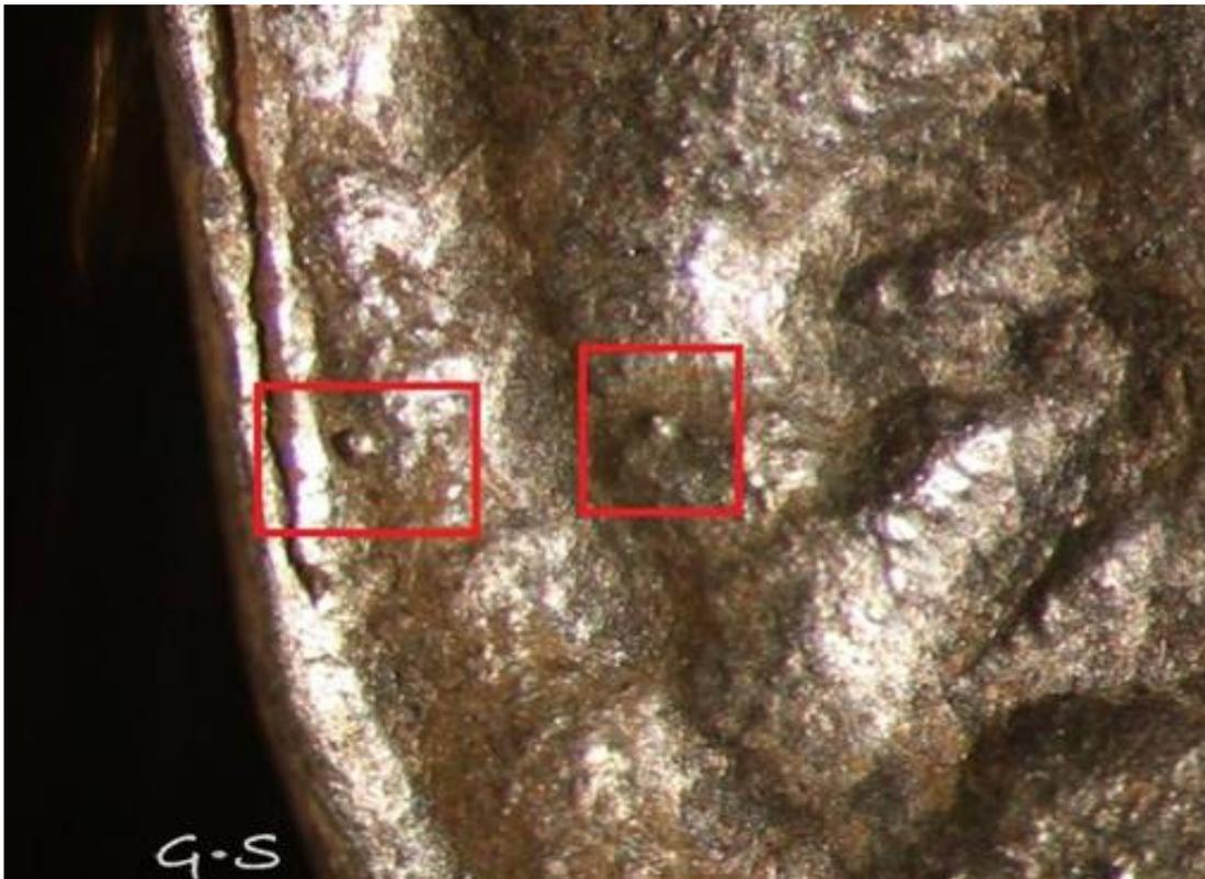
*Imagen 14.7. Burbujas de fundición sobre un denario falso de Septimio Severo. Colección GS.*
