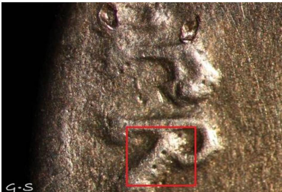
*Imagen 14.2. Burbujas de fundición sobre un denario falso de Gens Proclia. Colección Máximus.*
