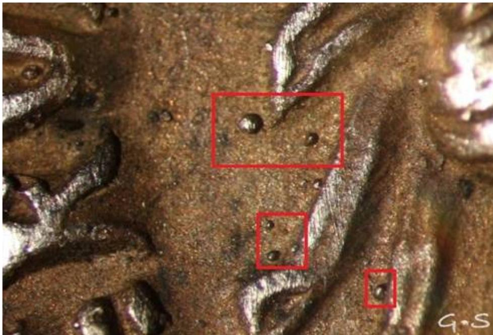
Imagen 14.14. Burbujas o depósitos de plata en una moneda fundida de Nerva. Colección GS.
