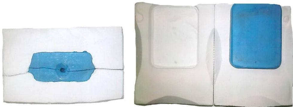
*Imagen 3.1. Molde de escayola en el que se ha introducido la moneda que vamos a clonar y rellenado con silicona líquida. Foto izquierda, vista de frente, y foto derecha, vista desde arriba. Abajo a la derecha, el molde una vez abierto.*
