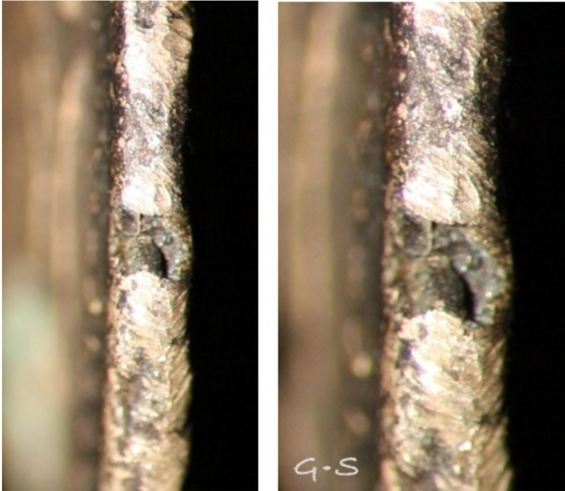
*Imagen 15.5. Segundo clon con el rastro del bebedero pulido. A 25 y 40 aumentos respectivamente. Colección GS.*
