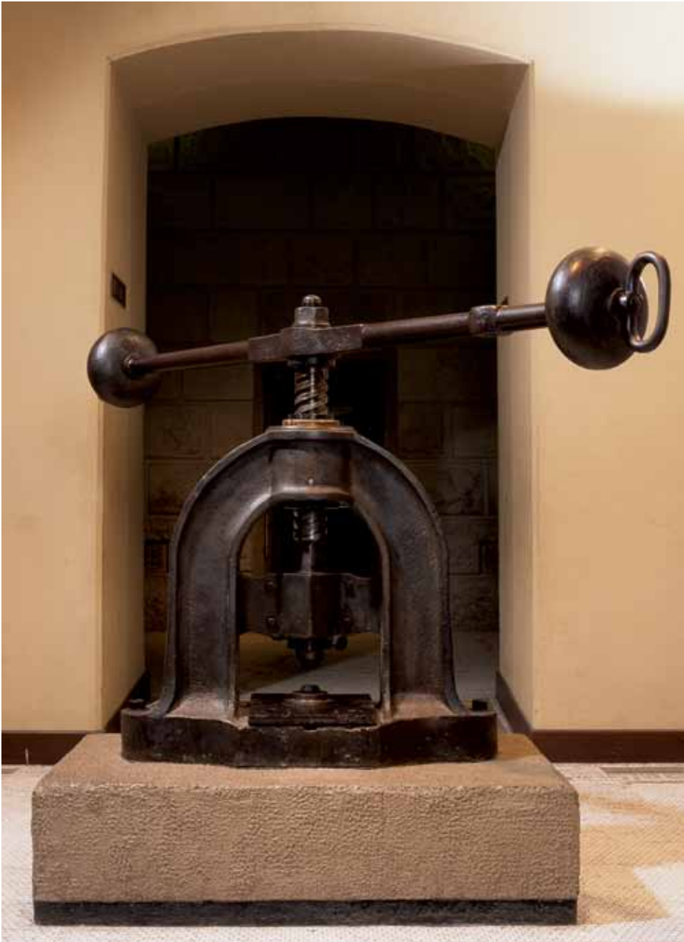
► Prensa de acuñación utilizada por la Casa de Moneda de Quito. Museo Numismático del Banco Central del Ecuador
